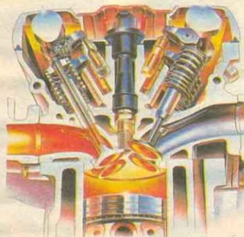
Двигатель автомобиля «Мицубиси-Галант»: два распределительных вала, гидравлические компенсаторы клапанного зазора — типичные для четырехклапанных моторов. Внешний вид машины — см. ЗР, 1992, № 1.
