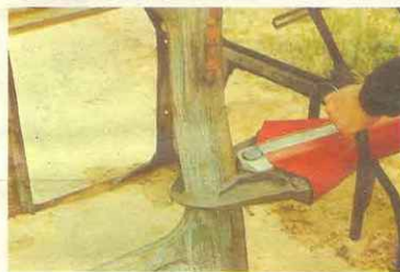
Гидравлические ножницы легко перекусывают стойку двери. Работать ими удобно. Весят они в зависимости от исполнения до 19 кг и развивают усилие резания на кромках до 29 тонн. Максимальное раскрытие лезвий — 125 мм.
